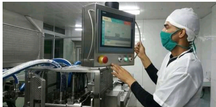
La nueva termoconformadora permite la elaboración de una tonelada de crema por hora. Foto: Rafael Hernández Rosell
